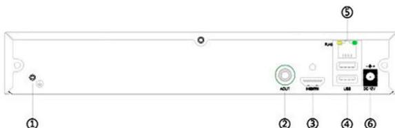
1. Ground 2. Audio Ausgang 3. HDMI Ausgang 4. USB
